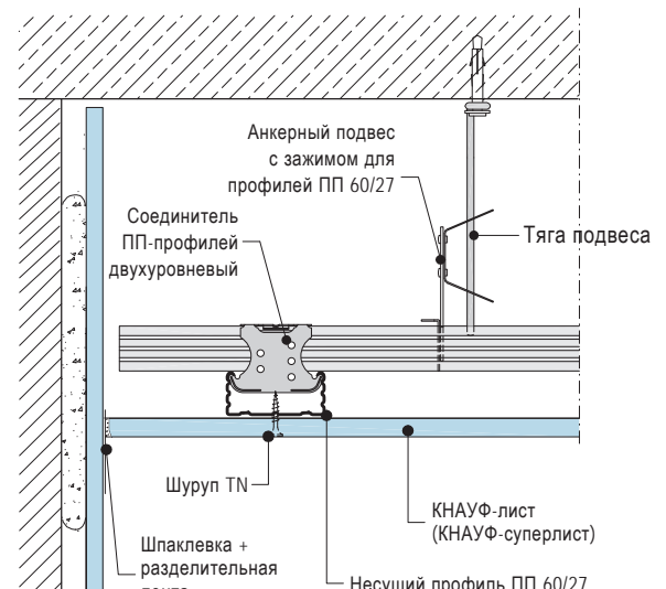
Примыкание к стене
