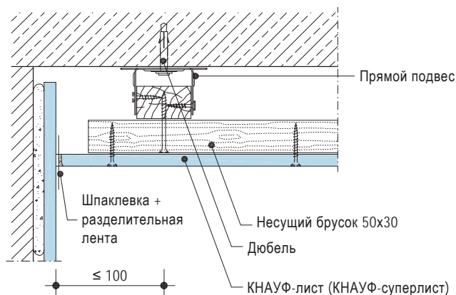
Примыкание к стене
