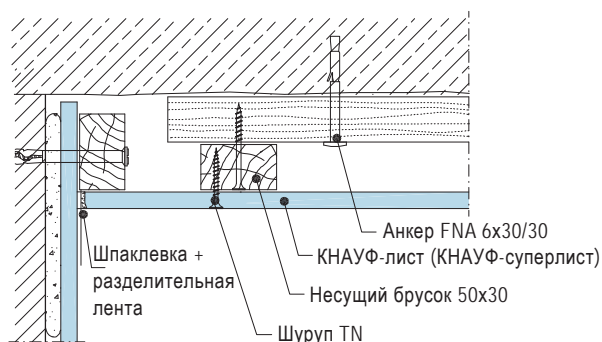
Примыкание к стене
